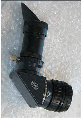
Das Bild links zeigt eine mögliche Kombination (Sektion 08), bestehend aus Baader T-Adapter (BTA #240 8160 Teil 21), Zeiss T2 Wechselring (#245 6321 Teil 6 und Teil 7), einem unserer T2 Prismen und einem Baader Eudiaskopischen Okular  $f = 30 \text{ mm}$ .
