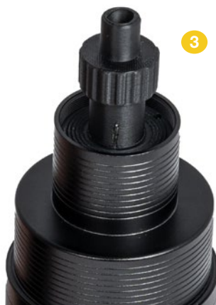
Bild 2: Schrauben Sie den Vorspannring heraus, indem Sie das kleine Werkzeug (③) senkrecht auf den Vorspannring setzen. So kann es den eigentlichen Filter nicht berühren.
