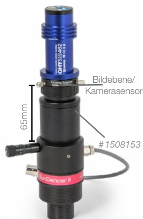
Eine Planetenkamera mit 1¼"-Steckhülse. Eine 40-mm-T-2-Verlängerungshülse sorgt für den idealen Arbeitsabstand von 65 mm vom T-2-Gewindeboden zum Kamerasensor.
