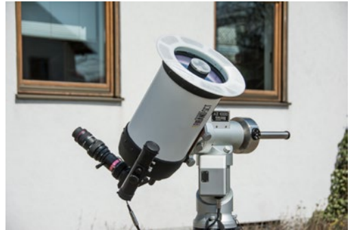
Der SunDancer II an einem 8" Triband SC mit in die Schmidtplatte integriertem D-ERF
