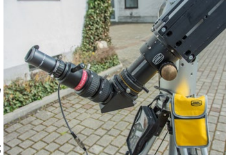
Der SunDancer II am Teleskop mit Zenitspiegel; Kontrollbox und Netzteil sind in der gelben Tasche.
