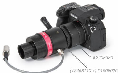
Eine DSLR mit Standard-T-Ring benötigt noch eine 10mm-T-2-Verlängerung. Ein Standard-T-Ring hat eine Baulänge von 55 mm – hier am Beispiel einer spiegellosen MFT-Kamera mit dem Micro Fourthirds T-Ring (mit 19 mm Verlängerung) #2408330
