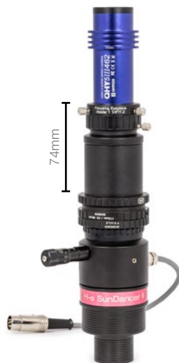
Der SunDancer II mit Telekompressor und der zusätzlich nötigen 40mm-Verlängerungshülse
