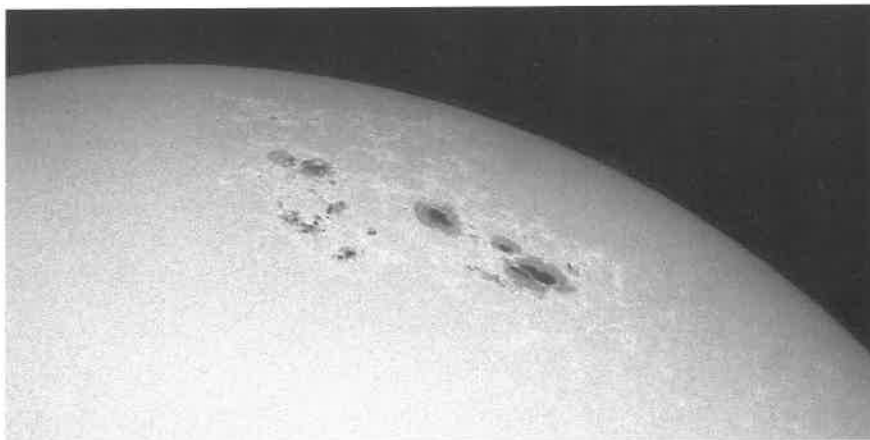
Abbildung 10: Diese Aufnahme zweier großer Sonnenfleckengruppen am Sonnenrand wurde von Herrn Dr. Poersch am 15. 4. 1991 mit seinem 130/1200-mm-Selbstbau-Newton-Teleskop aufgenommen. Herr Poersch benutzte hierzu ein Objektivfilter aus unserer photographischen Sonnenfilterfolie. In der gesamten Umgebung der Fleckengruppen werden die hellen Fackelgebiete sichtbar, die aufgrund der Mitte-Rand-Abdunklung am Rand der Sonnenscheibe besonders gut zu erkennen sind.
